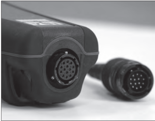
Abbildung 5. Beachten Sie den codierten Stecker. Die Kabel- und Instrumentenanschlüsse passen nur zusammen, wenn die codierten Abschnitte richtig ausgerichtet sind.
